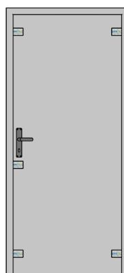
Aux points de réglage des étapes 2 et 3, ajuster aussi longtemps que nécessaire pour que la carte bancaire reste coincée au niveau des cinq points de mesure. Alors seulement, la porte sera montée correctement et présentera son efficacité acoustique maximale.
